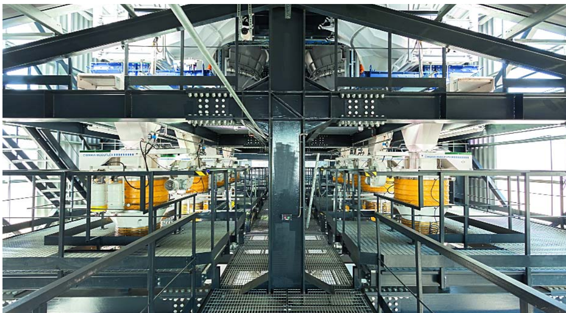
RIGA BULK TERMINAL. ОБОРУДОВАНИЕ БЕСПЫЛЕВОЙ ЗАГРУЗКИ СЫПУЧИХ МАТЕРИАЛОВ (САХАРА–СЫРЦА И ЗЕРНОВЫХ ПРОДУКТОВ) В ВАГОНЫ С АВТОМАТИЗИРОВАННОЙ СИСТЕМОЙ ВЗВЕШИВАНИЯ И ДОЗИРОВКИ. НАКОПИТЕЛЬНЫЕ БУНКЕРА ОБОРУДОВАНЫ ВИБРАЦИОННЫМИ РАЗГРУЗОЧНЫМИ УСТРОЙСТВАМИ.
