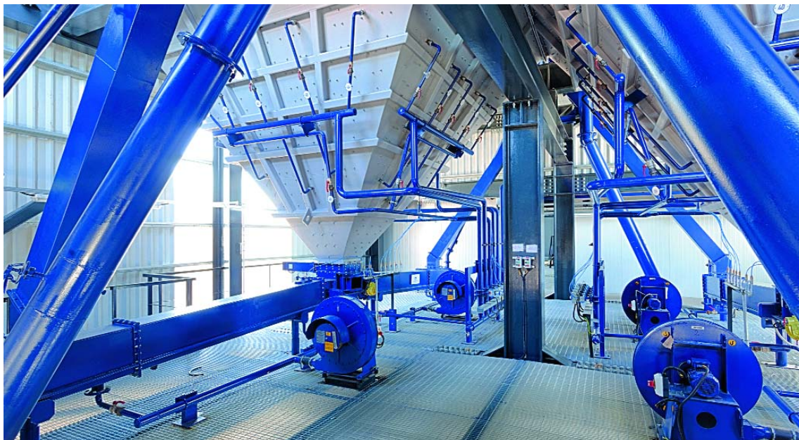
RIGA BULK TERMINAL. ОБОРУДОВАНИЕ БЕСПЫЛЕВОЙ ЗАГРУЗКИ ГЛИНОЗЁМА В ВАГОНЫ С АВТОМАТИЗИРОВАННОЙ СИСТЕМОЙ ВЗВЕШИВАНИЯ И ДОЗИРОВКИ. НАКОПИТЕЛЬНЫЕ БУНКЕРА ОБОРУДОВАНЫ СИСТЕМОЙ АЭРАЦИИ ДЛЯ ОБЕСПЕЧЕНИЯ ОПТИМАЛЬНОЙ ТЕКУЧЕСТИ.
